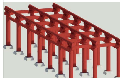
陸奥国分寺の回廊の BIMモデル
